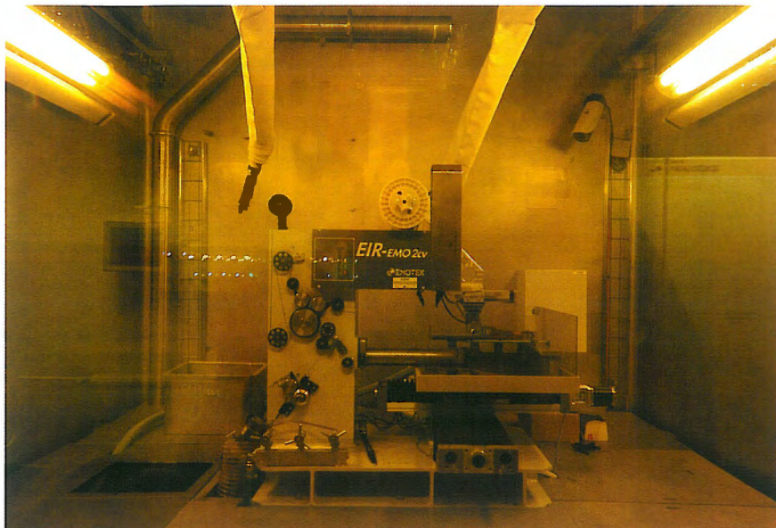
Elektrojiskrová řezačka pro přípravu zkušebních těles
